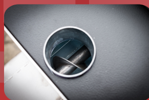
Interni pužni transporter
